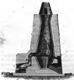
Fig. 152. — Four à chaux à cuisson continue.
